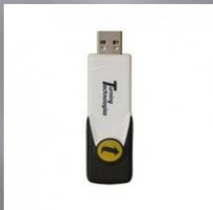
Ресивер не требует установки драйверов. Радиочастотная технология обеспечивает дальность действия 60 метров, при этом нет необходимости находиться в зоне видимости пульта ResponseCard. По размеру ресивер равен приблизительно размеру большого пальца и может накапливать до 1000 ответов.
