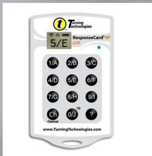
ResponseCard RF LCD – это новейшая версия клавиатурного пульта ResponseCard RF, спроектированная таким образом, чтобы обеспечивать визуальное подтверждение вводимой пользователем информации. На его жидкокристаллический (ЖК) экран выводится информация о выбранном варианте ответа, параметрах канала связи и уровне зарядки батареек.
